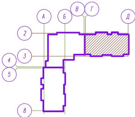
1. Лист с местами возможной установки наружных блоков кондиционеров выдается для ТСЖ.
